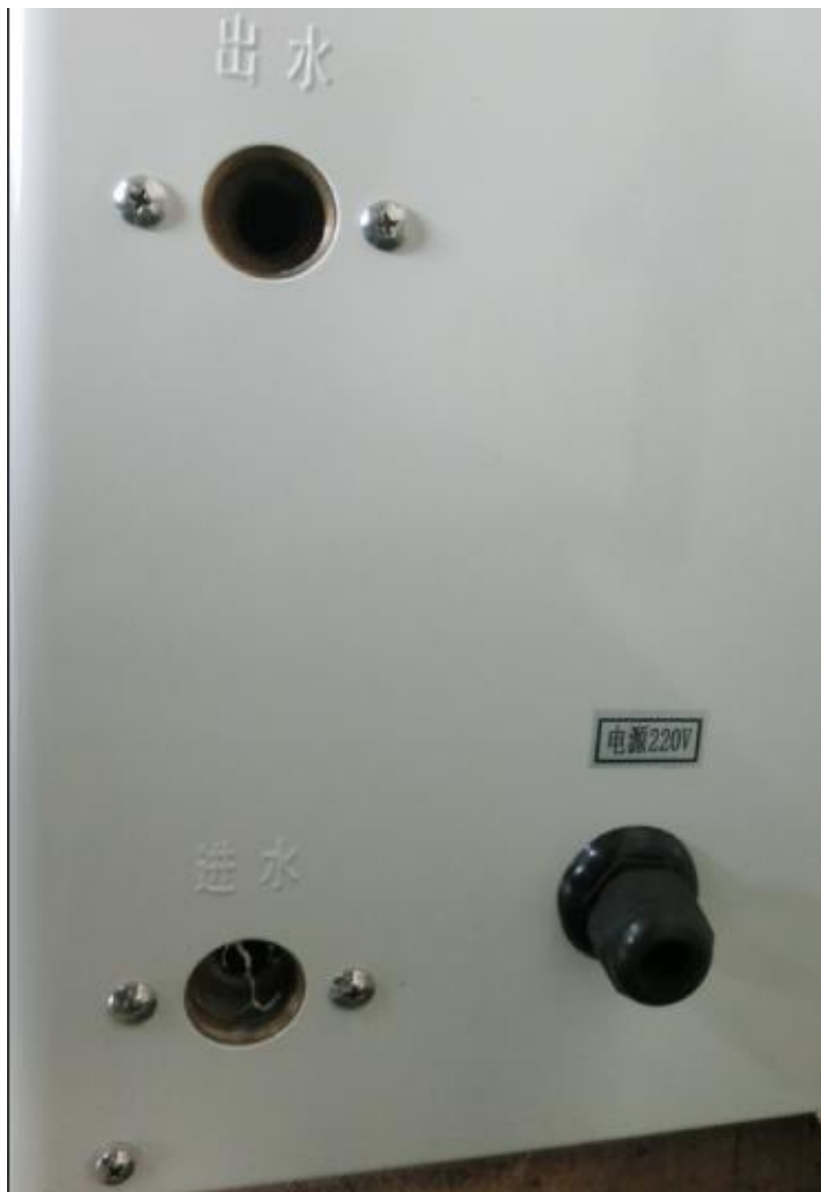
进、出水口及电源线入口位置
