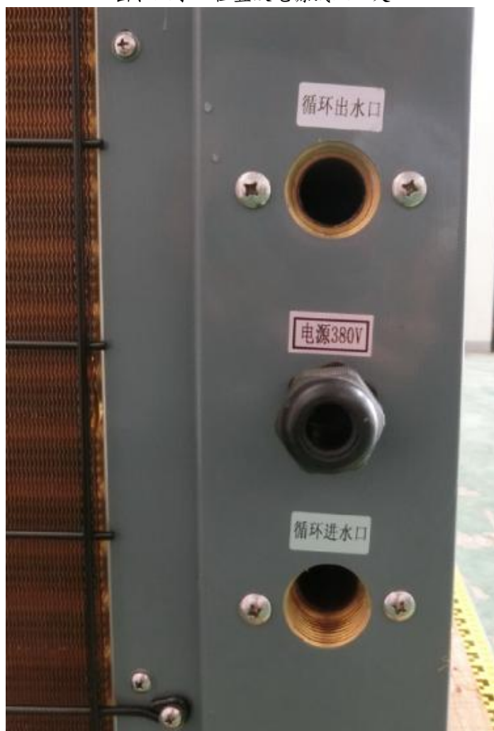
出、入水口位置及电源线入口处
